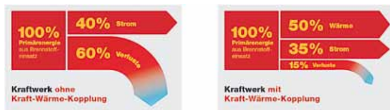
Verlustvergleich: Kraftwerke mit und ohne Kraft-Wärme-Kopplung
